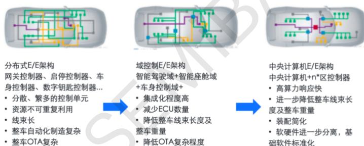
汽车域架构演变，图源：网络信息
